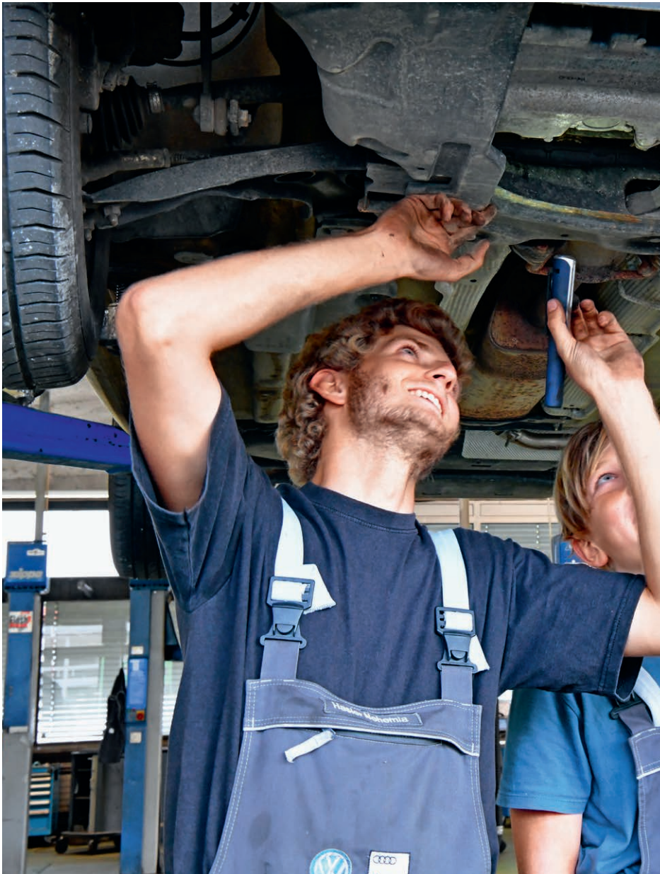
Automobil-Mechatroniker Nehemia Hasler zeigt einem «Schnupperstift» worauf es ankommt beim Öffnen der Ölablassschraube vor dem Ölwechsel.
